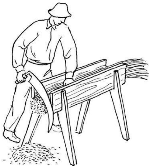
Obrázek 132 Řezání sečky (řezanky) – pří- pravek domácí výroby.
