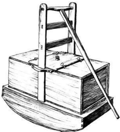
Obrázek 224: Dřevěná kolébavá cí maslinka.
