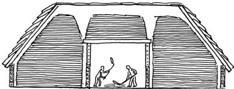
Obrázek 119: Plná stodola. Schéma vrstvení úrody obilí (žníva, zboží) do přístodůlků; vpravo a vlevo obilí tvrdého – žito, rži, na patrech měkkého; mezi stěnami stodoly a obilím větrací mezery
