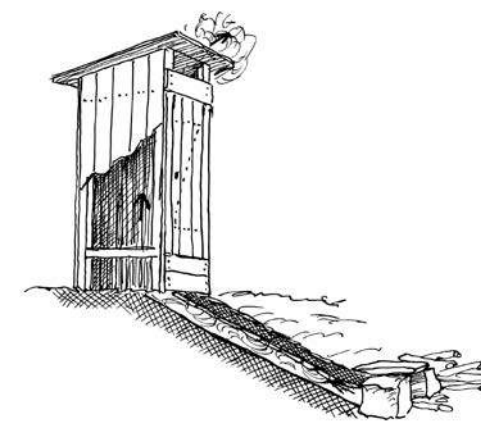
Obrázek 197: Udírna prkenná s topeništěm vpředu.
