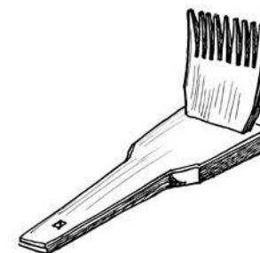
Obrázek 62: Dřevěný drhlen vsazený do lopatovité podložky délky 80 cm. Ta se zaklesla do lavicové sedačky nebo mezi trámy stěny či oploty a zajistila se závlačkou. Pracovnice seděla na nízké stoličce. Podle dochovaných kusů se celková délka drhlenů pohybovala okolo 80 cm, délka zubů činila 20 cm.
