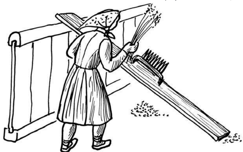
Obrázek 63: Drhlen zhotovený kovářem. Na kramli délky asi 30 cm jsou nakovány 18 cm dlouhé zuby s průřezem čtvercovým nebo kruhovým. Hranaté provedení je méně výhodné, neboť na hranách zubů se vlákna lnu zadržávala. Při práci se nástroj vbil do fošny nebo trámu jedním koncem pozvednutého na oplotu přístodůlku, druhým spočíval na zemi. Pracovalo se u něho vstoje. Pro dvě a víc pracovnic se trám položil mezi dvě lavice. Dělnice pak u drhlenů seděly střídavě na obou stranách trámu.
