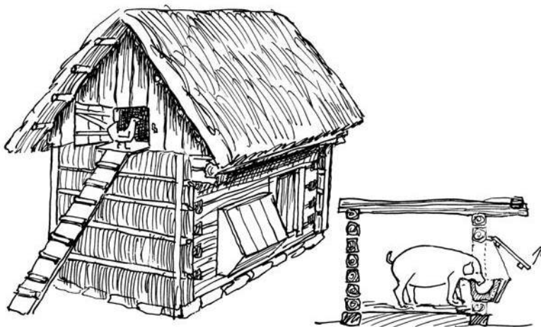
Obrázek 163: Dvojúčelový sroubek, dole prasečí chlívek, nad ním kurník.
