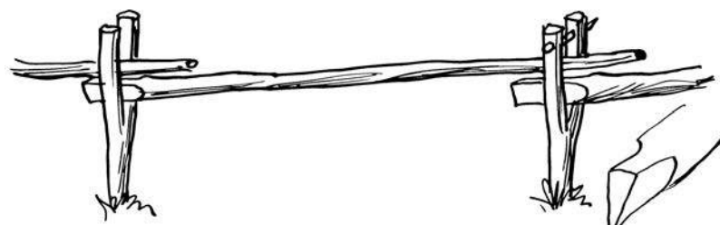
Obrázek 124: Honty upravené přitesáním, aby lépe zapadly do rozsoch samorostových somíků.
